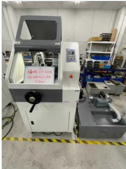
**金相切割机:** 无论是手动还是自动还应该注意以下几个通用指标:可切割样品的尺寸:根据不同的切割机可安装的切割轮尺寸, 可以得出不同的切割机可切割样品的能力。这与切割轮尺寸, 切割轮夹持法兰的尺寸以及夹持平台的尺寸相关。切割轮安装主轴的尺寸和可变径尺寸, 紧固法兰尺寸:这个尺寸是安装切割轮时使用, 配合切割能力的工具。冷却液水箱的泵送量和过滤级别:足够的泵送量和有效的过滤是切割冷却效果的保证。由于切割的使用环境和用途, 配备切割机还需要考虑:良好的清理保养以及防锈等使用习惯。根据样品切割需求的配套切割轮的选型。
