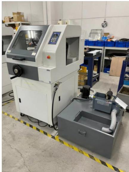
金相制样，经常要对小的、软的、脆的和异形的样品进行切割取样。由于精度要求高，有时材料特性很软、或很脆，都是比较难于切割的，这种情况，就需要一款低速精密金相切割机来解决问题了。可脉检测的低速精密金相切割机正合适！与同类低速精密切割机相比有以下几大特色：功率大 $\geq 100W$ 的电机功率，强劲有力，使样品切割变得轻松自如。配置更为人性化：其所配夹具、法兰、磨石及配重等配置齐全，使设备稳定性好，并能满足各种材料和形状各异的样品切割。触屏控制：大尺寸触摸屏控制，操作更简单容易。转速范围大 $\geq 0-600\text{rpm}/\text{min}$ 调速范围，无级变速，使之比同类设备的切割性能相比更突出，应用更为灵活和宽泛。以上这些特点，决定了这款金相切割机特别适合切割小的、软的、脆的、异形的样品。全自动金相切割机的应用及优势：切割后的工件不需研磨抛光处理，可直接进行显微硬度测试等检测。济南全自动金相切割机销售厂家
